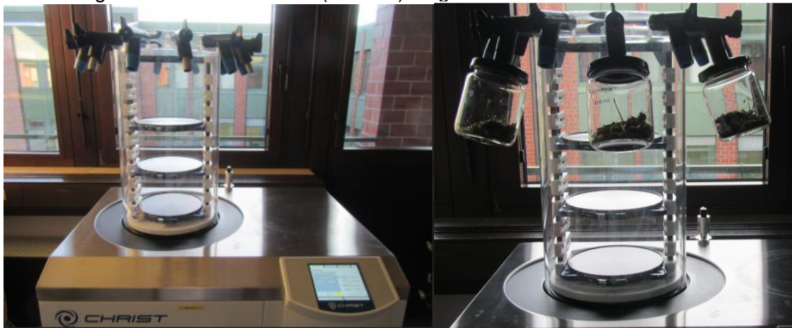
Abb. 12: Gefriertrocknungs-Laboranlage PMI317 von CHRIST
